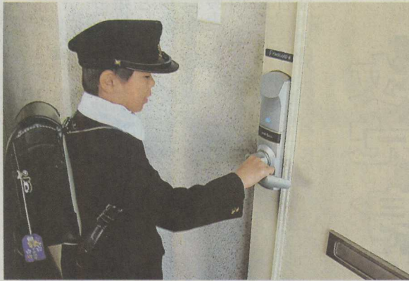
①指紋を認識する電子錠を取り付けた玄関。鍵を使わずに解錠できる。②解錠は、ドアノブに指を当てるだけで済む。
